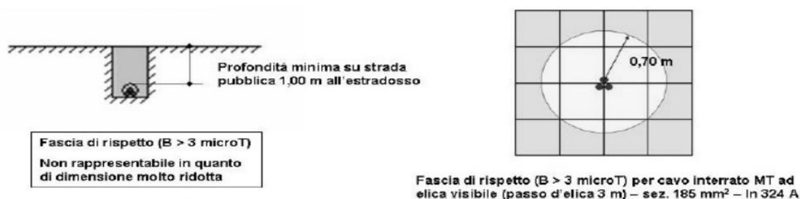
Figura 1: Curve di livello dell'induzione magnetica generata da cavi cordati ad elica – calcoli effettuati con il modello tridimensionale "Elico" della piattaforma "EMF Tools", che tiene conto del passo d'elica.
